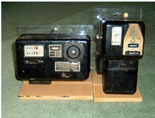
Links: kilowattuurmeter voor inworp van elektriciteitspenning rechts: tijdsklok waarin kwartjes werden ingeworpen.
